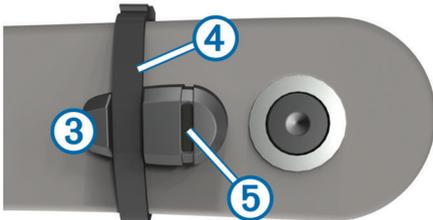
Der Abstand zwischen Pedalmagnet und GSC 10 darf nicht mehr als 5 mm betragen. Die Markierungslinien [5](#) auf dem Pedalmagneten müssen auf die Markierungslinien [6](#) am GSC 10 ausgerichtet sein.
